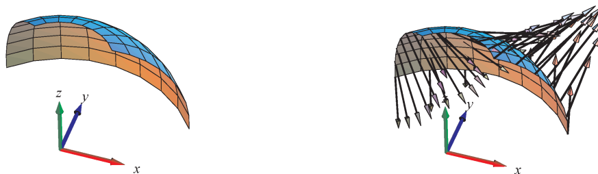
Figur 12.4: Et stykke af en kugleflade samt rotationen \text{rot}(\mathbf{V}) ved fladestykket er her vist for vektorfeltet \mathbf{V}(x, y, z) = (z^2x, x^2y, y^2z) . Vektorfeltet \mathbf{V} er ikke selv vist. Integrator8-kommandoen StokesFlux viser og beregner fluxen af rotationen igennem fladen. Se eksemplerne i Maple filen Int8D_FluxOgDivergens .
