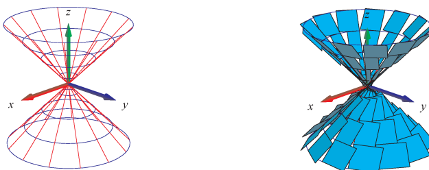
Figur 3.1: Kegle-fladen er givet ved parameterfremstillingen \mathbf{r}(u, v) = (u \cos(v), u \sin(v), u) , u \in [-1, 1] , v \in [-\pi, \pi] . Et system af koordinatkurver på fladen er vist til venstre og de tilsvarende areal-approximerende parallelogrammer er vist til højre. Figureerne er del af output fra Integrator8-kommandoen fladeInt .
