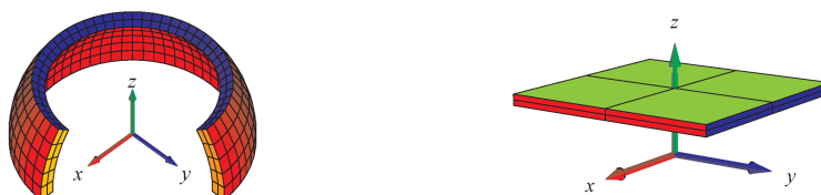
Figur 12.3: To skaller med lille tykkelse defineret ud fra forskellige grundflader med rand. Til venstre er grundfladen et stykke af en kugleflade, til højre er grundfladen et plant kvadrat.
