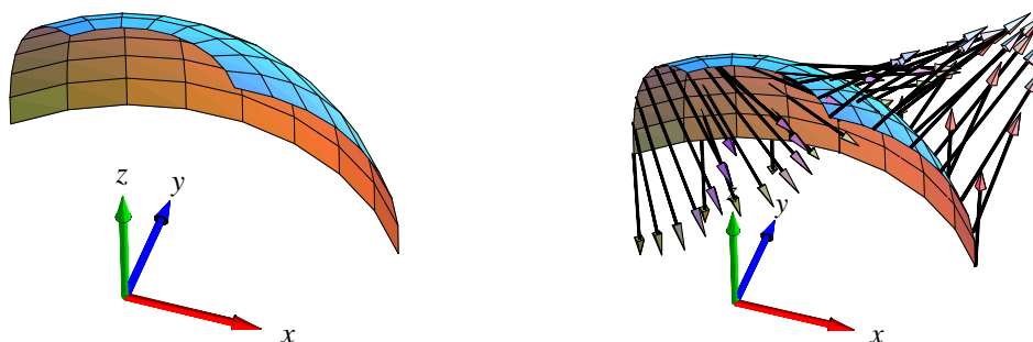
Figur 10.2: Et stykke af en kugleflade samt rotationen \text{rot}(\mathbf{V}) ved fladestykket er her vist for vektorfeltet \mathbf{V}(x, y, z) = (z^2 x, x^2 y, y^2 z) . Vektorfeltet \mathbf{V} er ikke selv vist. Integrator 3-kommandoen StokesFlux viser og beregner fluxen af rotationen igennem fladen. Se eksemplerne i Maple filen Int3D_FluxOgDivergens .
